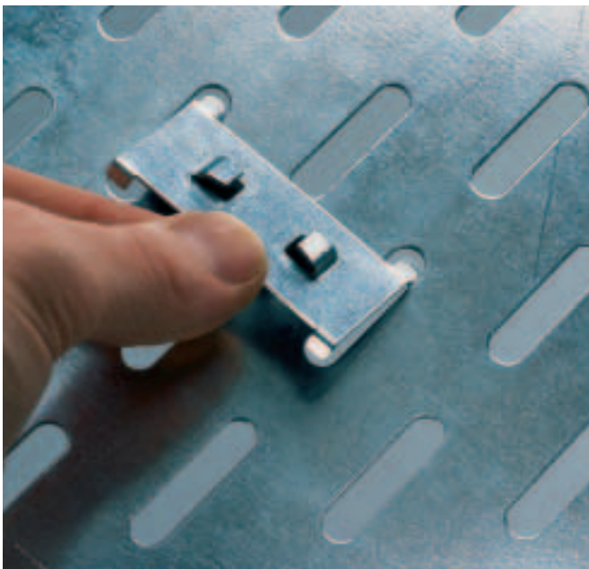
Einsetzen eines Klemmstücks »KS MKS/SKS« in eine MKS-Kabelrinne (Abstand ca. 3 Stück/Lieferlänge)
