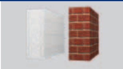
Massivwände aus Mauerwerk, Beton/Stahlbeton und aus Porenbeton-Bauplatten
