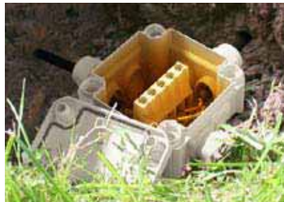
Der vollständig vergossene Kabelabzweigkasten erreicht Schutzart IP68. Die Kabelverschraubungen dienen lediglich der Zugentlastung.
