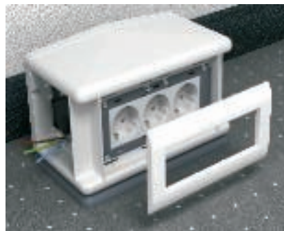
Installation Modul 45-Geräte mit S990-Abdeckungen in T4L und T8NL Leitungsöffnungen in Gerätebecher Telitank T4L vorbereiten und in Gehäuse einrasten. Modul 45-Gerät vor Leitungsanschluss in Telitank-Adapter einrasten. S990-Abdeckplatte von außen in Gehäuse einrasten.
