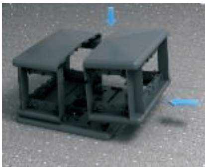
Montage Gehäuseoberteil bei T4L und T8NL Gehäuse von vorne auf Bodenplatte aufschieben und hinten herunterdrücken.
