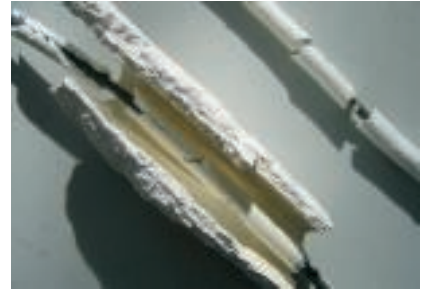
Funktionserhaltkabel mit isolierender Ascheschicht
