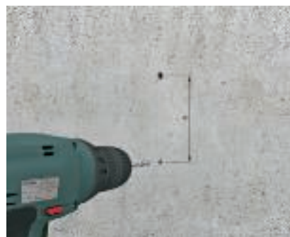
Montagevorbereitung Bohren \varnothing 5 mm mind. 60 mm tief; Bohrabstand: B 100 E - 88 mm, B 160 E - 105 mm, B 250 E - 113 mm. Bohrungen gut säubern.
