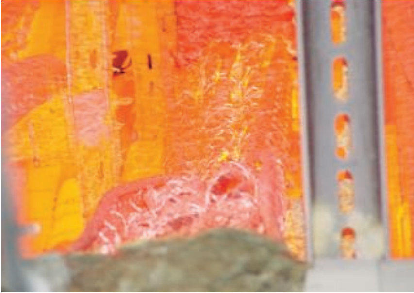
Blick in den Prüfofen: Nachglühen der Tragkonstruktion
