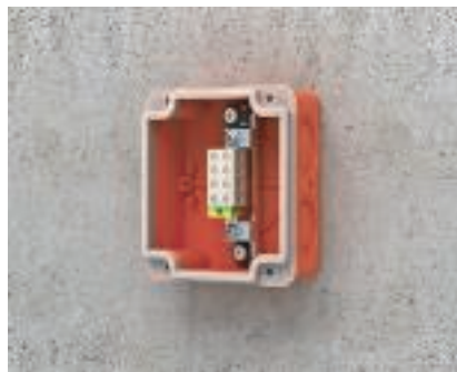
Montage Klemmblock Klemmblock mit Brandschutzschraubanker direkt in den Untergrund einschrauben. Antrieb T30, Anzugsmoment max. 3 - 8 Nm.
